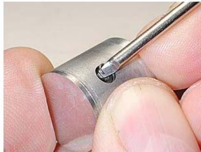
Die Kolbenbolzensicherungsringe können Sie mit dem Fingernagel einsetzen (sofern Sie diese in der Zwischenzeit nicht schon abgekaut haben :-). Stellen Sie sicher, dass der Sicherungsring korrekt in der Nut sitzt.
