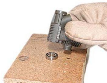
Unmittelbar danach (das Kurbelgehäuse hat noch die entsprechende Temperatur) müssen Sie ebenfalls das vordere Lager ausbauen. Hierzu können Sie eine runde Welle in das Gehäuse einführen (in diesem Fall ein Steckschlüssel), bei welcher der Durchmesser etwas kleiner ist als der des Innenrings des Hauptlagers, welches Sie soeben aus dem Gehäuse demontiert haben.
