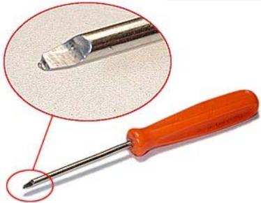
Um die Kolbenbolzensicherungsringe einfacher aus dem Kolben demontieren zu können haben wir uns mit Hilfe einer Schleifmaschine aus einem Schraubendreher ein spezielles Werkzeug angefertigt.
