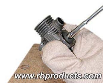
Üben Sie einen sanften Druck auf das vordere Lager aus, so dass es sich aus dem Gehäuse bewegt. Seien Sie vorsichtig und beschädigen Sie nicht die Innenseiten des Kurbelgehäuses!
